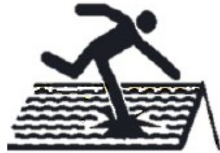
Sfondamento tetto o struttura non pedonabile
